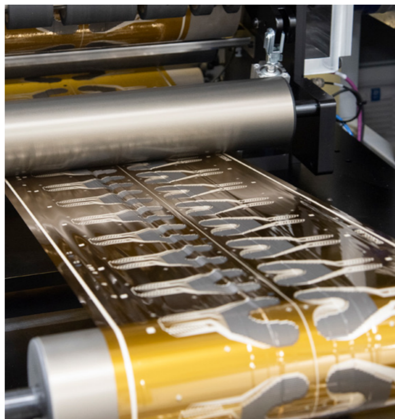
Die für einen Hersteller zahnmedizinischer Produkte gedruckten Folien, mit 10.000 flexiblen Drucksensoren, helfen Zahnärzten bei der exakten Messung des Kaudrucks ihrer Patienten.
