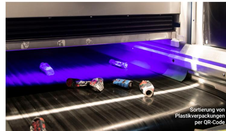
naue Materialzusammensetzung anhand des QR-Codes herauslesen und die Sortiermaschine so lenken, dass die Verpackung gezielt in den entsprechenden Behälter sortiert wird. Das menschliche Auge kann diesen Prozess nicht leisten.
